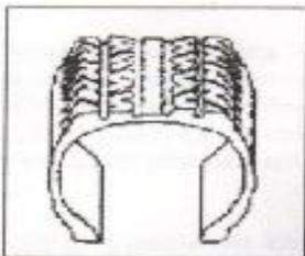
Por el contrario, si se transita con sobrepresión en las llantas, la banda de rodadura se desgasta en el centro, ya que es la única parte de su superficie que hace contacto con el suelo. Ello dificulta la maniobrabilidad y reduce la respuesta del sistema de dirección. Además repercute en la estabilidad general del automóvil.
