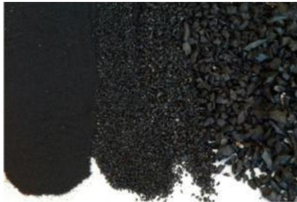
Figura 18.- Gránulos utilizados para el Ecoasfalto
