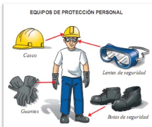
Figura 8: Equipo de seguridad.
